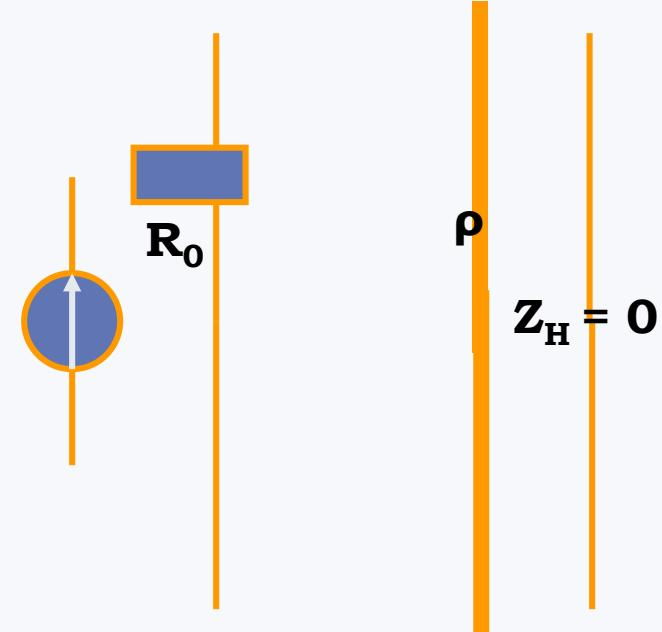
Узлы напряжения и пучности тока
