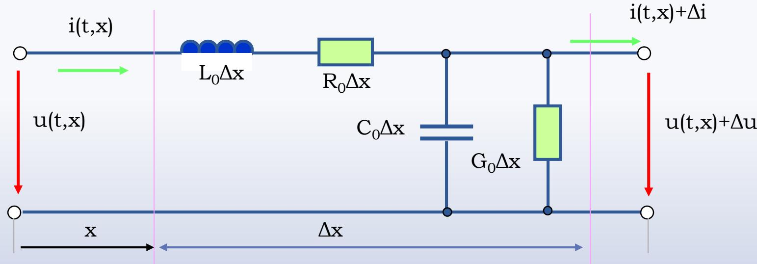
**Уменьшение напряжения** в конце участка линии  $\Delta x$  по сравнению с его началом **вызвано падением напряжения на индуктивности**  $L_0\Delta x$  и **сопротивлении**  $R_0\Delta x$ , а уменьшение тока происходит за счет **ответвления тока** через **емкость**  $C_0\Delta x$  и **проводимость изоляции**  $G_0\Delta x$
