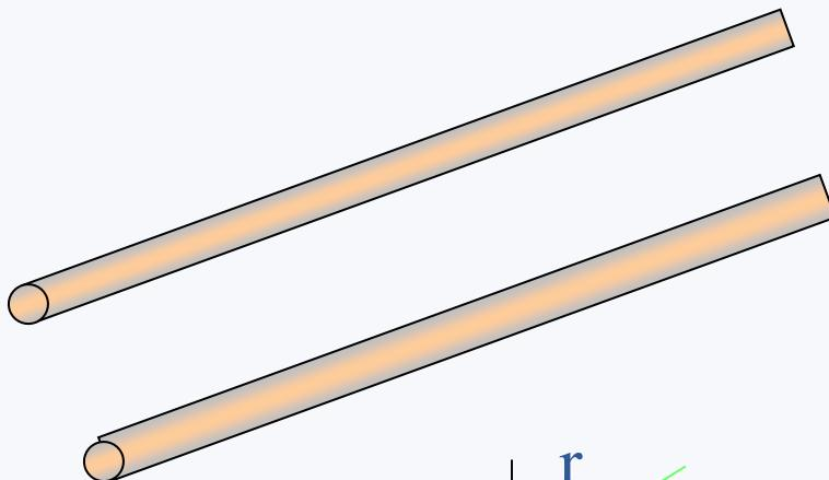
Открытая медная двухпроводная линия для радио частот образована двумя параллельными цилиндрическими проводниками на расстоянии  $D$  между осями и с радиусами  $r$ .
