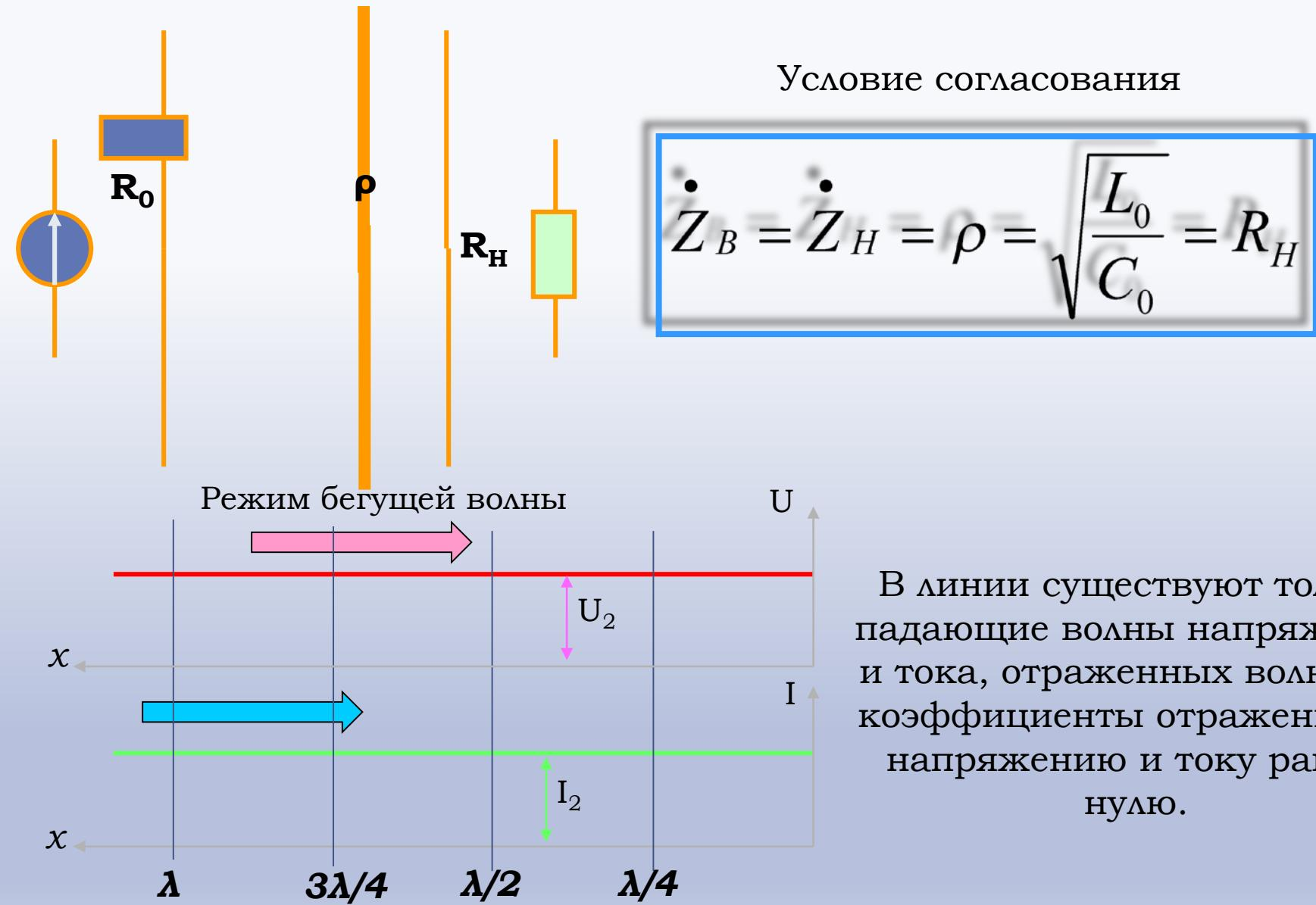
В линии существуют только падающие волны напряжения и тока, отраженных волн нет, коэффициенты отражения по напряжению и току равны нулю.
