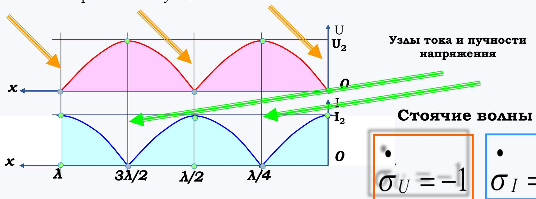
В режиме короткого замыкания входное сопротивление линии принимает вид
